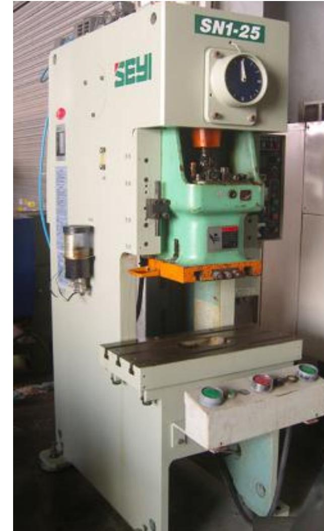
Name名称: 45吨低速精密冲床45T low speed precision punch
