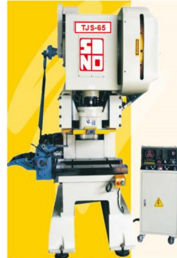
Name 名称: 80吨低速精密冲床 80T low speed precision punch
