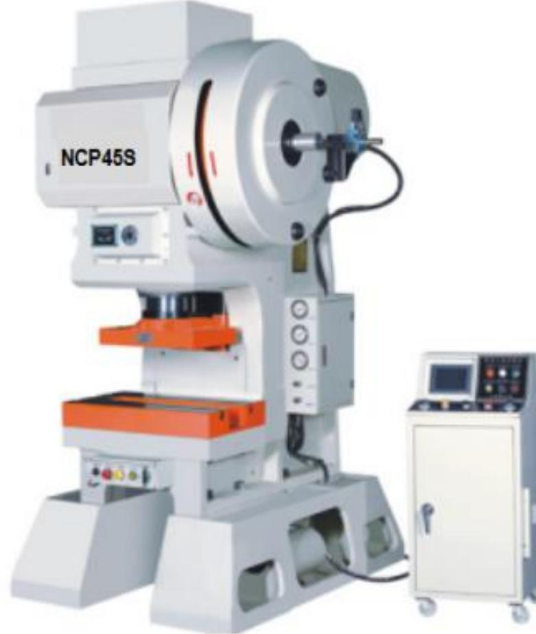
Name名称: 45吨高速精密冲床45T High speed precision punch
